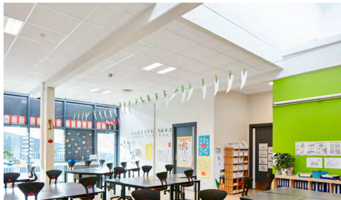
Doświetlenie sali oknem powyżej połaci dachu, Nordagerskolen Elementary School, Dania, fot. Teddy Strandqvist, Studio-e-se
